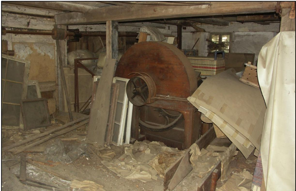
Die noch heute in Resten vorhandene Transmissionsanlage (am linken Bildrand sichtbar) konnte mittels verschiedener Riemenscheiben und einer Kupplung so geschaltet werden, dass entweder die Maschinen im Hause Nr. 123 oder die im Fabrikgebäude befindlichen Maschinen angetrieben werden konnten. Letzteres geschah mit dem bereits erwähnten, die Straße überspannenden Transmissionsriemen.
